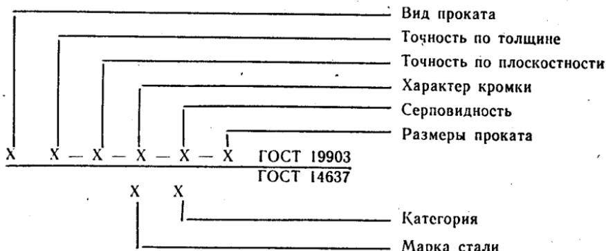
**Примечание.** Параметры и характеристики проката приведенные в схеме, если они не указаны в заказе, устанавливаются изготавителем и в обозначении не приводятся.
